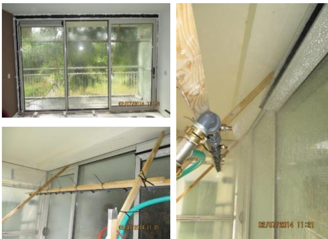
Figuur 1: beoordeling waterdichtheid scheidingsconstructie
